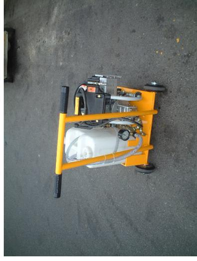
板ジャッキ専用ポンプ(プロトタイプ)試験片コンクリート破壊用のみに使用、吐出圧力40、80Kg/cm<sup>2</sup>(2段階調節付き)吐出量8L/min
