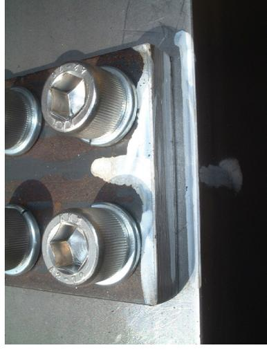
加圧後、固定ボルト破損
