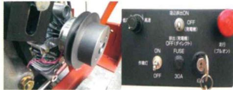
走行を安全に制御する電磁クラッチ付走行装置で、プルスイッチでON、OFFでき、コンクリート切断等に威力を発揮し、走行速度再設定不要です。
